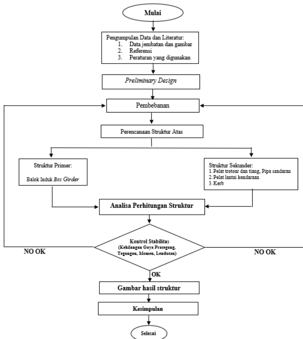
Gambar 2. Diagram Alir Perencanaan Jembatan Kali Kethek (Sumber: Penulis)
