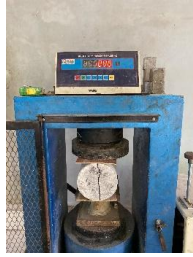
Gambar 5. Pengujian Kuat Tarik Belah Beton
