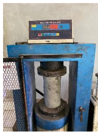
Gambar 3. Pengujian Kuat Tekan Beton
