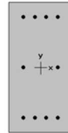
Gambarr 20 Konfigurasi Penulangan Sloof
