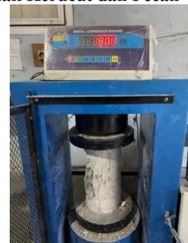
**Gambar 9** Tipe Pola Retak Kerucut & Pecah
