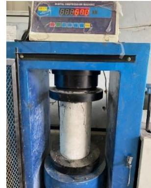
**Gambar 8** Tipe Pola Retak Kerucut (*Cone*)
