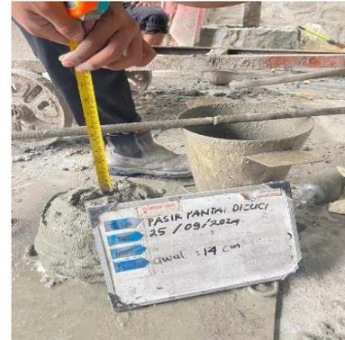
**Gambar 6.** Pengujian *Slump*
